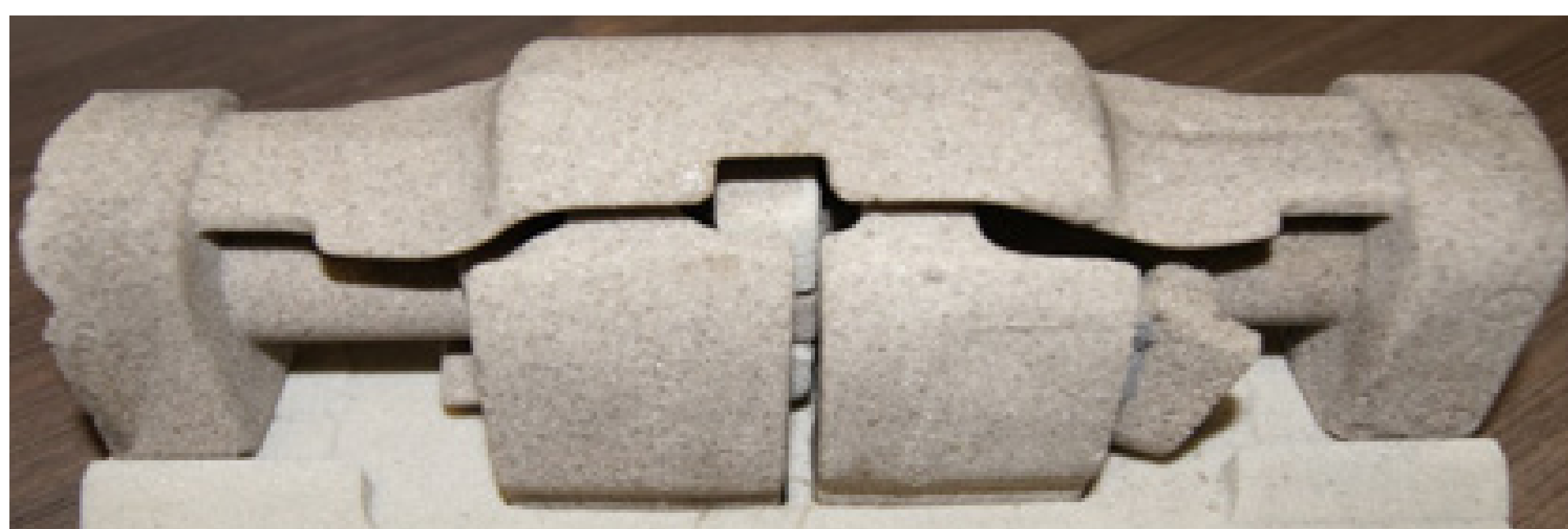
IMAGEN 1. Ejemplo de un conjunto corazón ensamblado usando adhesivos.
