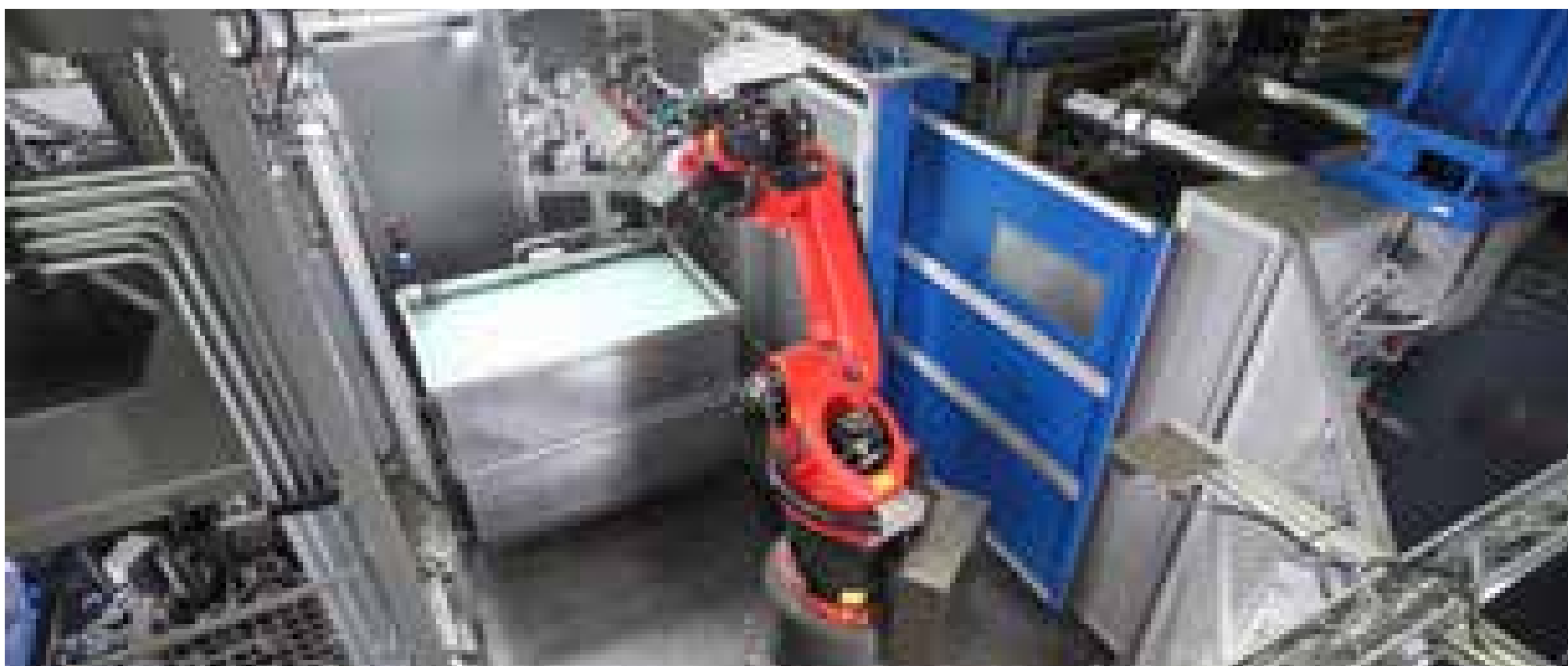
Luego de quitar la pieza ya colada el robot se detiene frente a un control equipado con sensores Infrarrojo.
